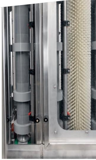
Der gezielte Wasserstrahl beim Reinigen und Spülen erfolgt durch Stangen mit entsprechenden Düsen, die das gesamte Glas perfekt abdecken.
