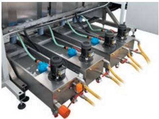
Auf Rädern montierte Wannen für eine einfachere Beförderung in der Reinigungsphase. Das in den Wannen enthaltene Wasser durchquert zwei verschiedene Filtrierungsstufen, bevor es wieder in der Maschine zirkuliert. In der Wanne des ersten Bürstenpaars befindet sich ein Heizwiderstand mit zugehörigem Thermostat für die Wassererwärmung. Die Möglichkeit das Wasser auch in den anderen Wannen zu erwärmen, erleichtert das Entfernen von Rückständen und das Trocknen der Glasplatten. (opt)
