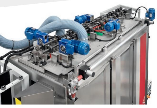
Aus Rollen und Bürsten bestehendes Antriebssystem im oberen Teil der Maschine für einen besseren Schutz vor Wasser und für eine einfache Inspektion und Wartung.
